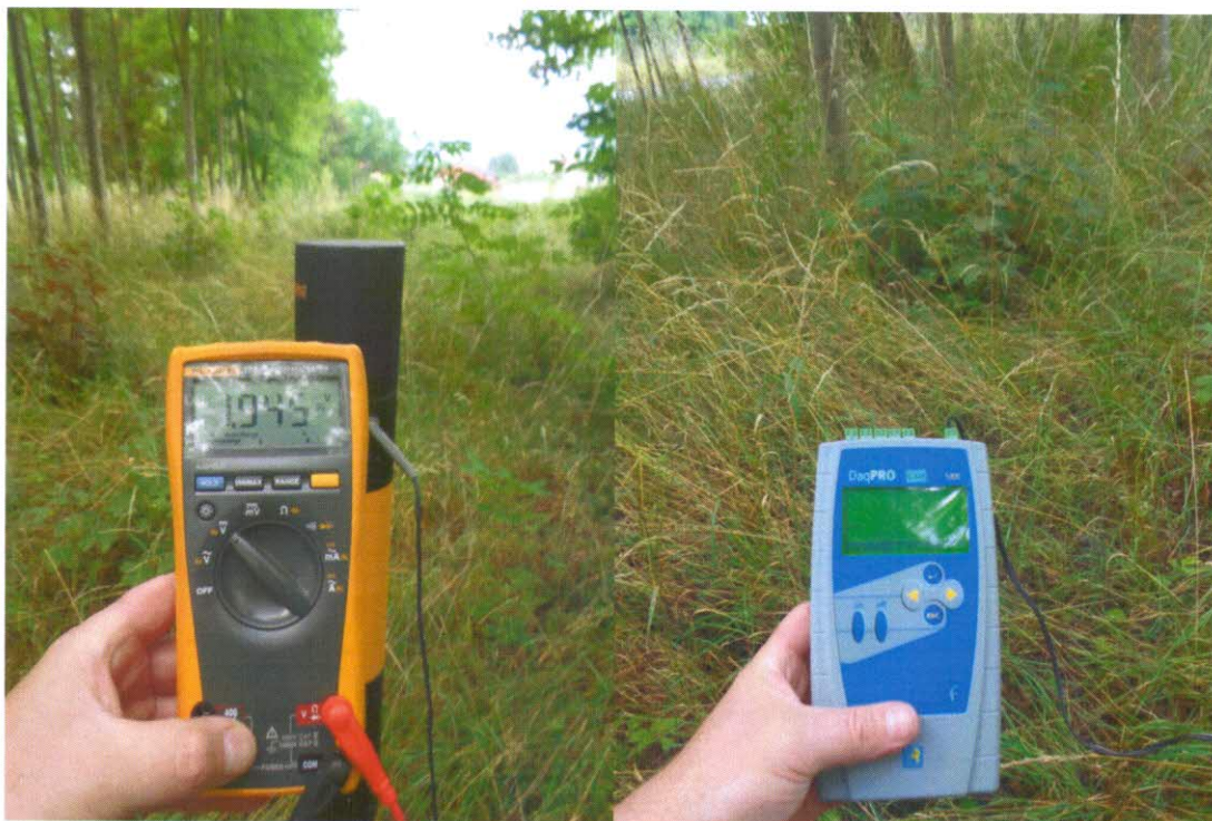
Obr.č.4 Měření potenciálu potrubí-půda
