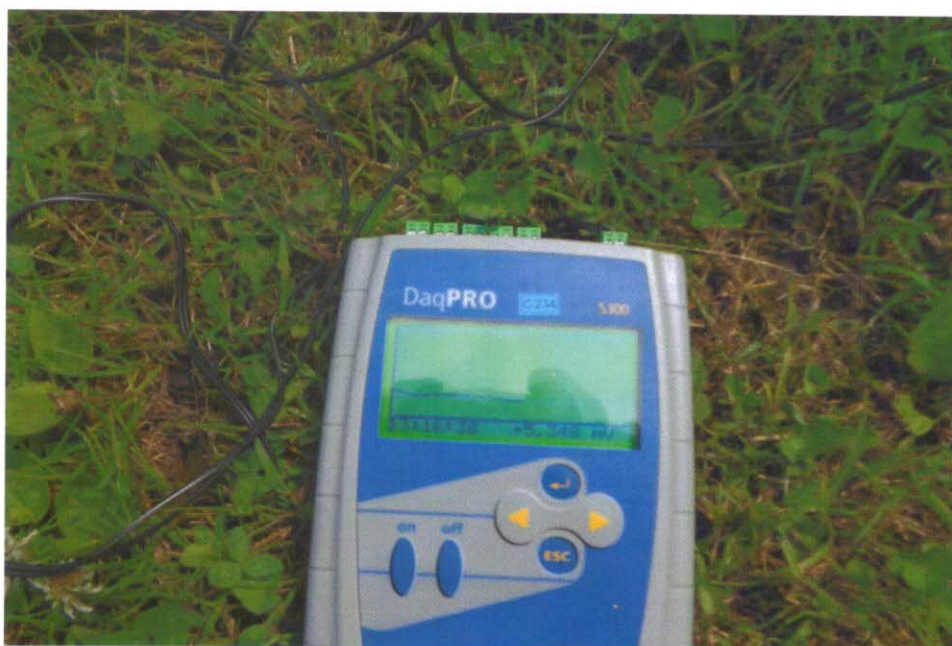
Obr.č.6 Naměřené hodnota potenciálu potrubí-půda
